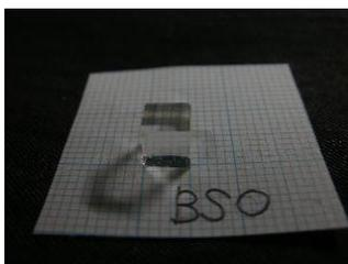
組成式  $\text{Bi}_4\text{Si}_3\text{O}_{12}$
