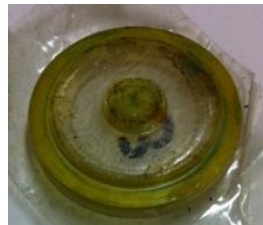
図 2-2 : 使用した ^{137}\text{Cs} 密封線源
