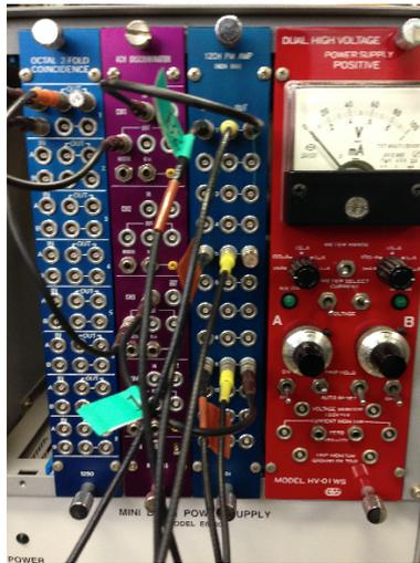
図 5.13: モジュール。右から Bias 電源、Discriminator、PM AMP、Coincidence。
