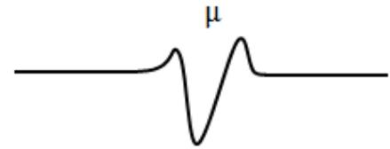
図 3.2.2 入射  $\mu$  粒子の信号
