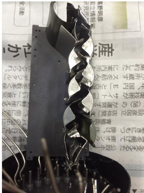
図 2.4.3 実際の光電子増倍管のダイノード
