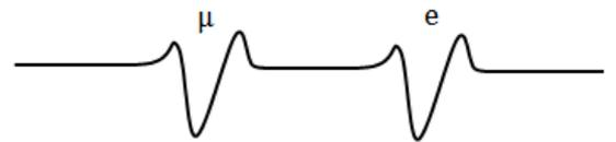
図 3.2.4 入射  $\mu$  粒子と崩壊電子の信号
