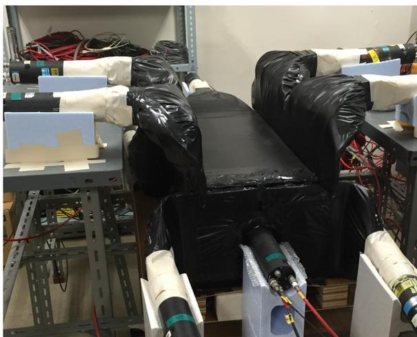
図 10: 実際に使用したシンチレーションカウンター
