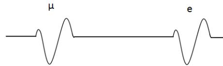
図 7:  $\mu$  粒子がメインシンチレーター内で電子に崩壊するとき
