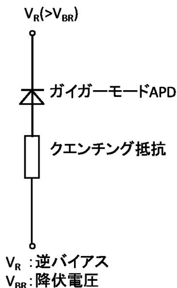
図 2.3: MPPC の 1 ピクセル
