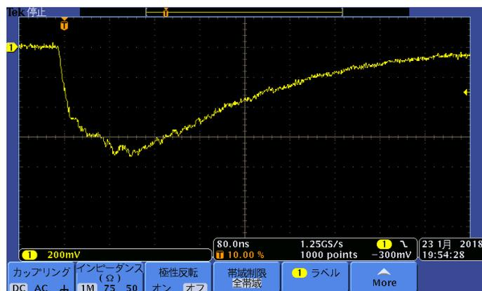
図 6.4: 3mm 角 MPPC と  $^{22}\text{Na}$  線源を用いたときの波形のスナップショット
