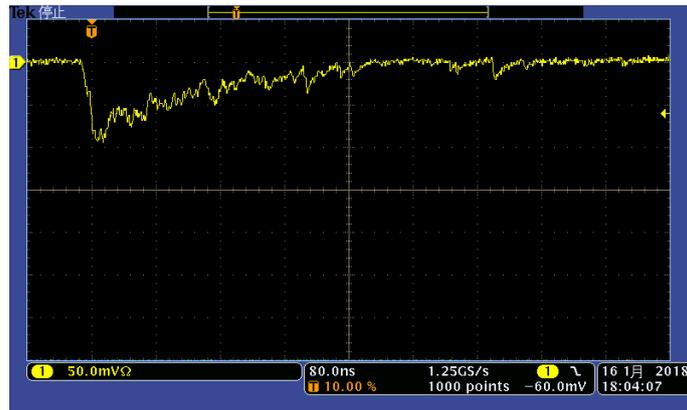
図 6.2: 1mm 角 MPPC と  $^{137}\text{Cs}$  線源を用いたときの波形のスナップショット
