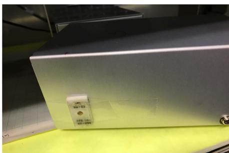
図 7.3: アルミシャーシに線源を貼り付けている様子
