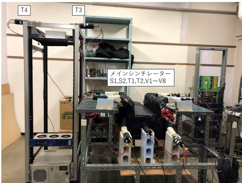
図 2.5 実際のシンチレーターの配置
