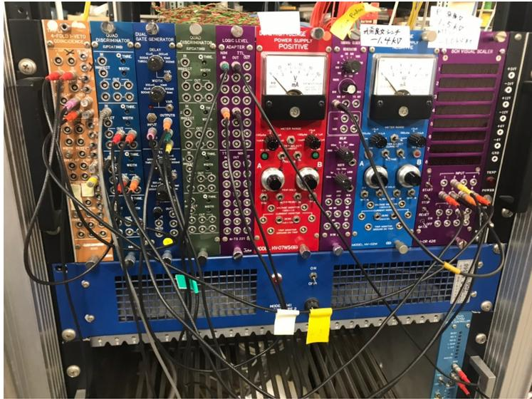
図 3.1 NIM モジュールのセットアップ写真
