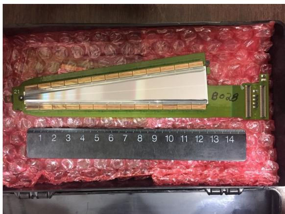
図 1.3 PHENIX 実験におけるシリコンセンサー (FVTX)
