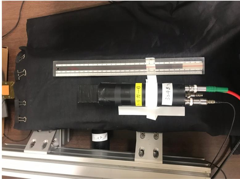
図 6.4 外部トリガーシリコンセンサーとシンチレーションカウンタセットアップ
