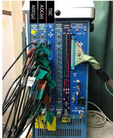
図 2.10 本実験で使用している CAMAC モジュール
