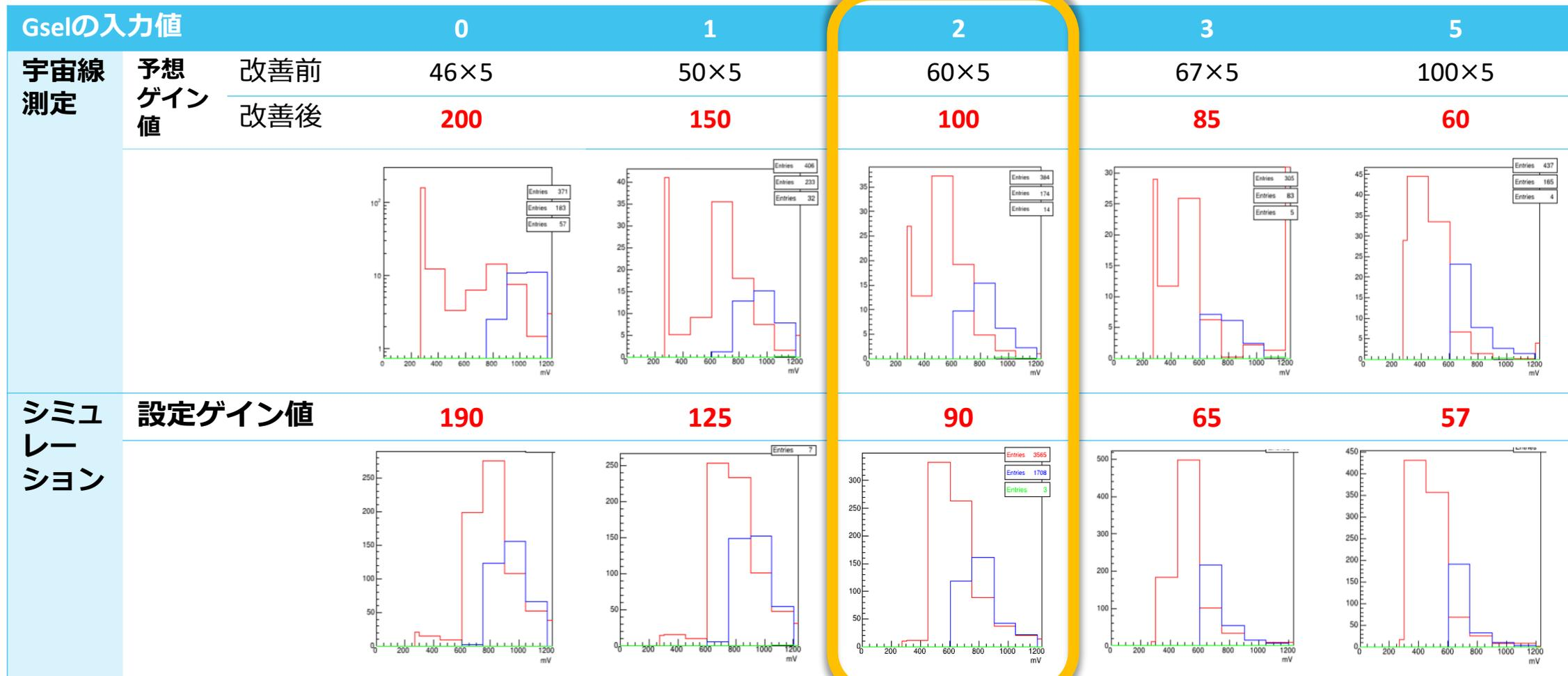
シミュレーションでも宇宙線測定と同じようなGselとエネルギー損失の関係がわかる。
