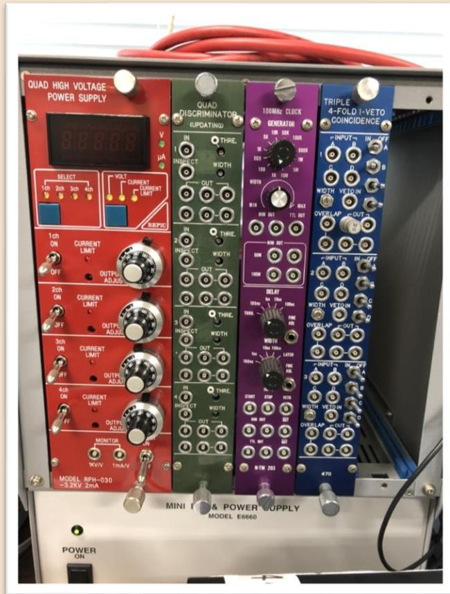
赤：High Voltage 高電圧を印加する電源モジュール
