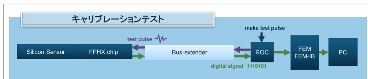
図 3.5 キャリブレーションテストにおける信号の流れ
