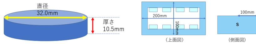
図 2.21 左図：取り付けたネオジウム磁石、 右図：磁石を取り付けるヨーク
