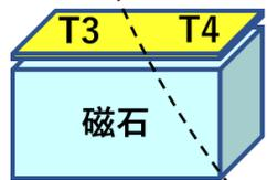
ヨーク内にネオジウム磁石を二段に、計16個つけ、T3とT4の下に設置する。
