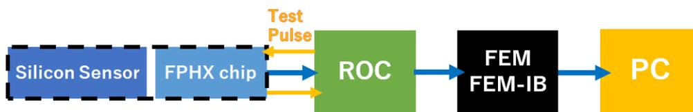
図 2.7 キャリブレーションテストのセットアップ。
