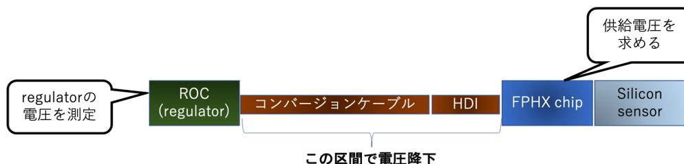
図 4.1 regulator への供給電圧の見積もり方法。
