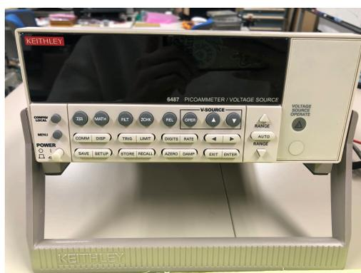
図 3.5: ピコアンメータ/電圧源 (Model 6487, KEITHLEY)
