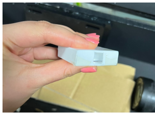
図 8: 反射材で包んだ BGO 結晶シンチレーター
