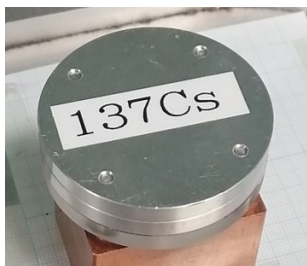
図 11: 放射線源 ^{137}\text{Cs} 円板形のアルミニウム とアクリル板で作られた ケースに入っている
