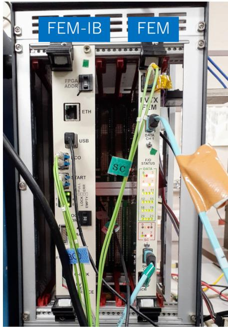
図 2.6 FEM(右) と FEM-IB(左) の写真
