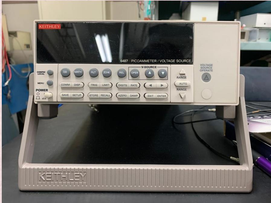
ピコアンメーター…Si chip に高電圧をかける
