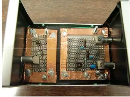
図 4.3: LED 点灯による MPPC 特性測定のためのアルミ Box 内のセットアップ
