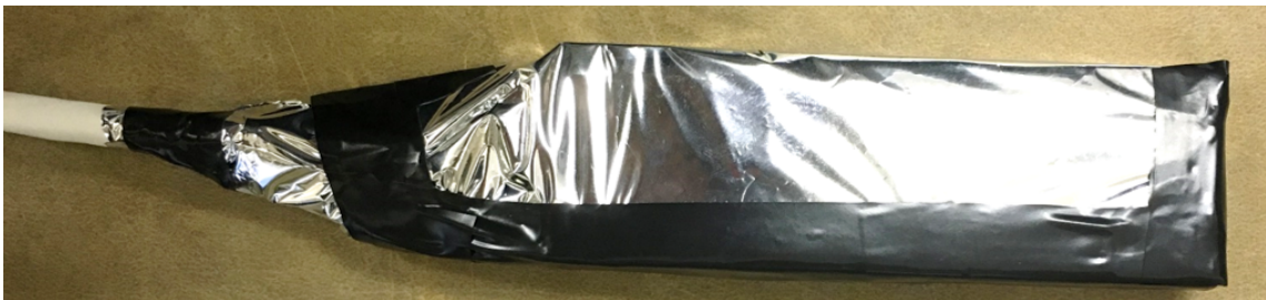
図 4.6: アルミマイラーとケーブルを導通させ、静電遮蔽したところ。
