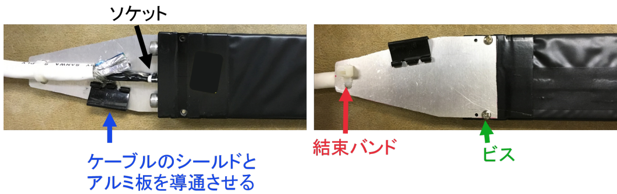
図 4.5: SCI の制作過程でアルミ板の上にケーブルとシンチレーターを固定したところ。
