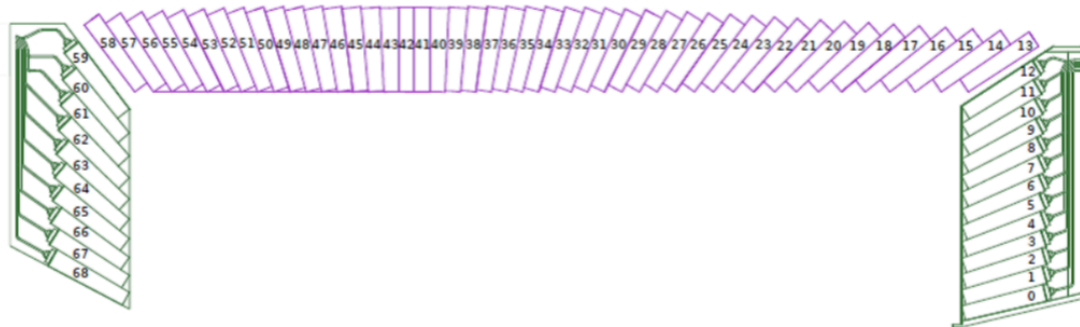
図 3.3: ECL の \theta_{ID} の定義。 \theta の小さいカウンターから順に 0 68 の番号を割り当てている
