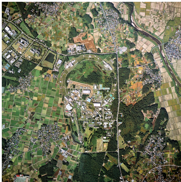
図 1.4: 高エネルギー加速器研究機構 (KEK) の航空写真。中央の東西約 1 km、南北約 2 km の区画が KEK の敷地である。敷地内南東部分に入射器となる直線型加速器、北側・西側・東側の敷地境界近くに接するよう円形 (正確には角を丸めた正方形) に建設されているのが電子と陽電子のリングを収めたトンネルである。
