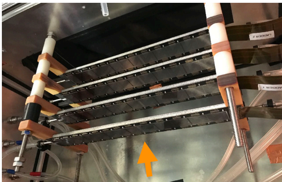
図 4.2 箱の中のシリコンモジュール配置図
