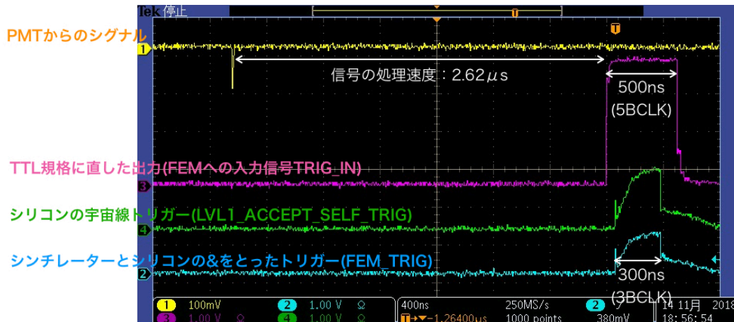
図 3.8 外部トリガーモードのオシロスコープ観測画面。黄色：シンチレーションカウンタからのアナログ信号、マゼンタ色：TTL 信号に変換後のシンチレーションカウンタのトリガー信号、緑色：シリコンセンサー自身のトリガー信号、青色：両方のトリガー信号のコインシデンスをとった FEM から出力されるトリガー信号
