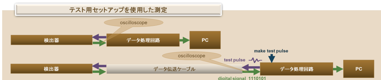
図 4.17 出力波形を観測するセットアップの概略図
