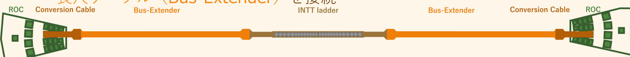
INTT ラダーと読出し回路の概略図
