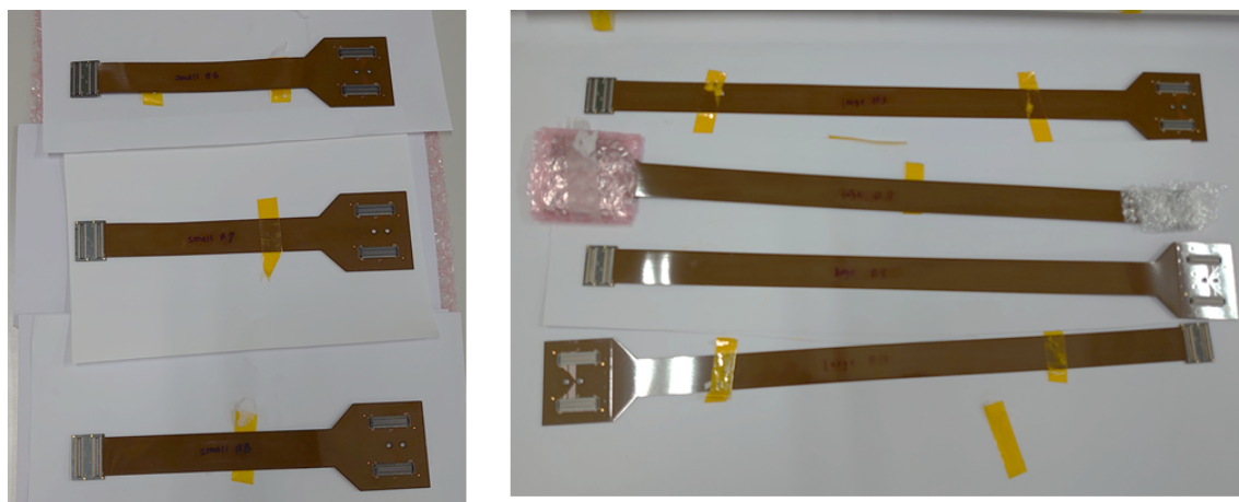
図 2.5 FPC 製コンバージョンケーブル。左: small(20cm)、右: large(40cm)。
