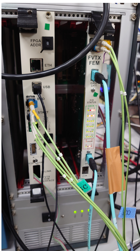
図 2.9 VME クレートに装着された FEM-IB(左) と FEM(右)。
