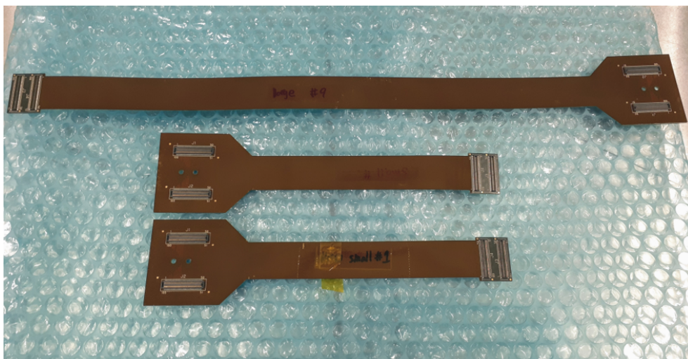
図 2.5 FPC 製の Conversion cable の写真 (上) 40 cm, (中, 下) 20 cm
