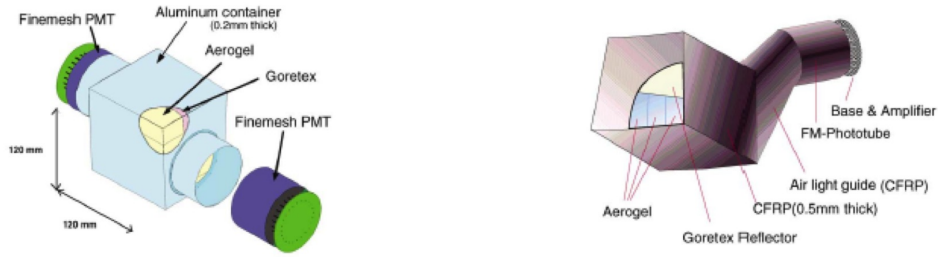
図 12 ACC のカウンターモジュール: 左:バレル領域のモジュール、右:エンドキャップ領域のモジュール
